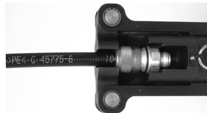
Figura 5 – Conector debidamente asentado en el hueco escariado del armazón
